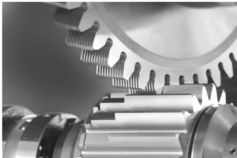
Figura N°1- Rasatore in presa su un ingranaggio a denti dritti e fascia larga
